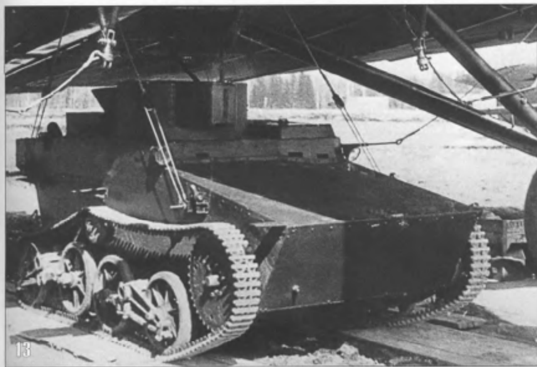
13. Серийный танк Т-41 на подвеске под фюзеляжем бомбардировщика ТБ-3 во время демонстрации техники воздушно-десантных войск. Московский военный округ, 1945 год (ГП).
