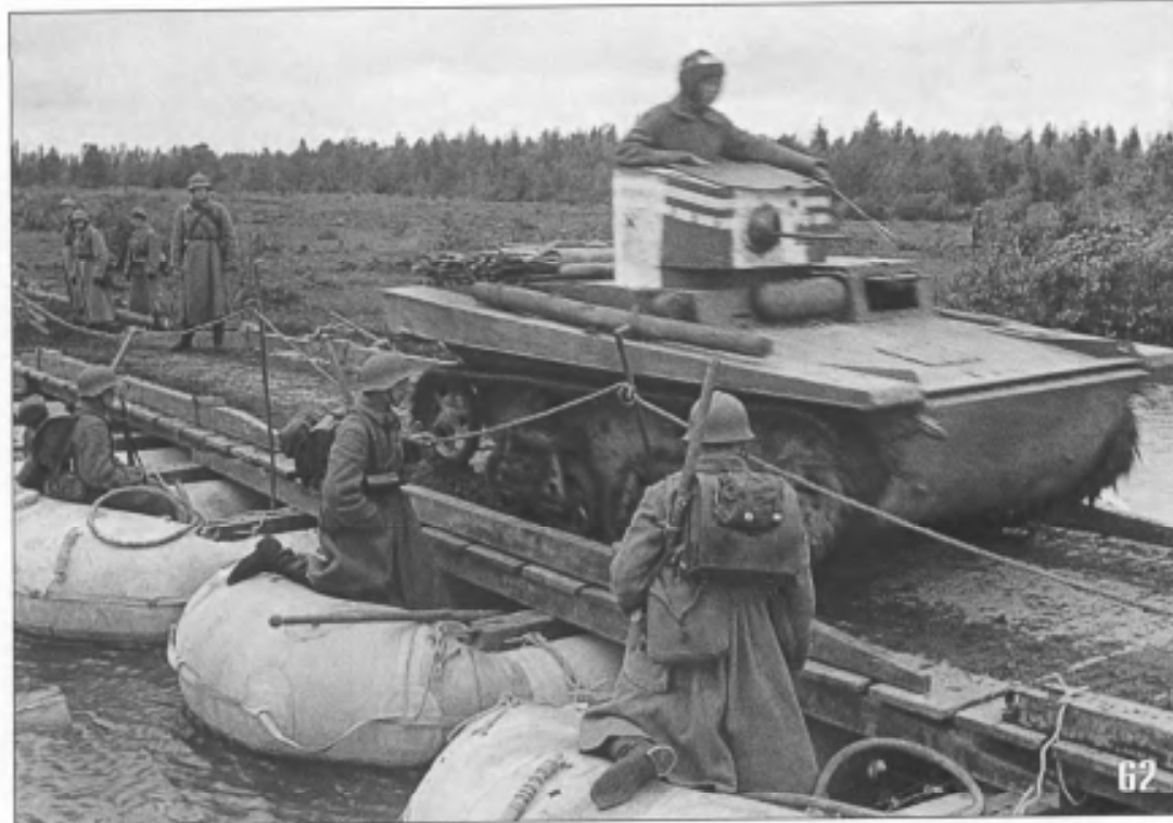
61, 62. Танк Т-37А (с бронекорпусом производства Ижорского завода) форсирует реку по понтонному мосту. Маневры войск Белорусского военного округа, сентябрь 1936 года (АСКМ).
