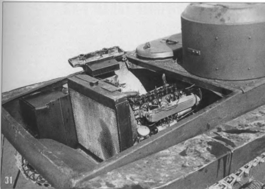
31. Танк Т-37А с дизельным двигателем «Перкинс». НИИТБ полигон, 1935 год. Хорошо виден сам двигатель, радиатор и топливный бак (АСКМ).
