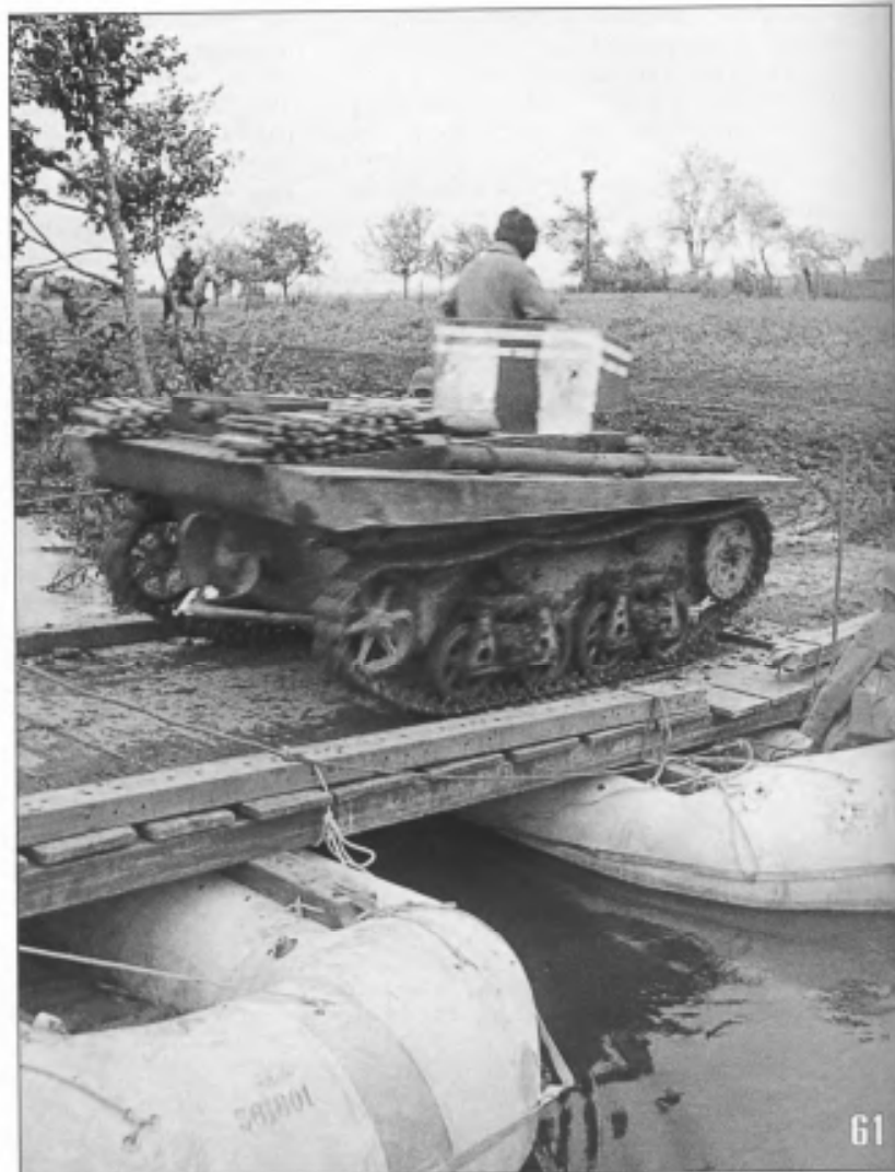
61, 62. Танк Т-37А (с бронекорпусом производства Ижорского завода) форсирует реку по понтонному мосту. Маневры войск Белорусского военного округа, сентябрь 1936 года (АСКМ).
