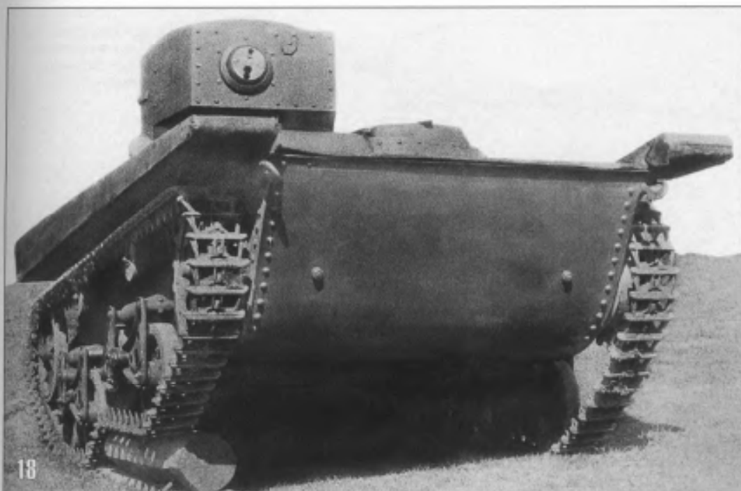
18. Танк Т-37А с бронекорпусом производства подольского завода имени Орджоникидзе на испытаниях. Лето 1935 года. На этих фото хорошо видна работа тележки подвески при преодолении препятствия (АСКМ).
