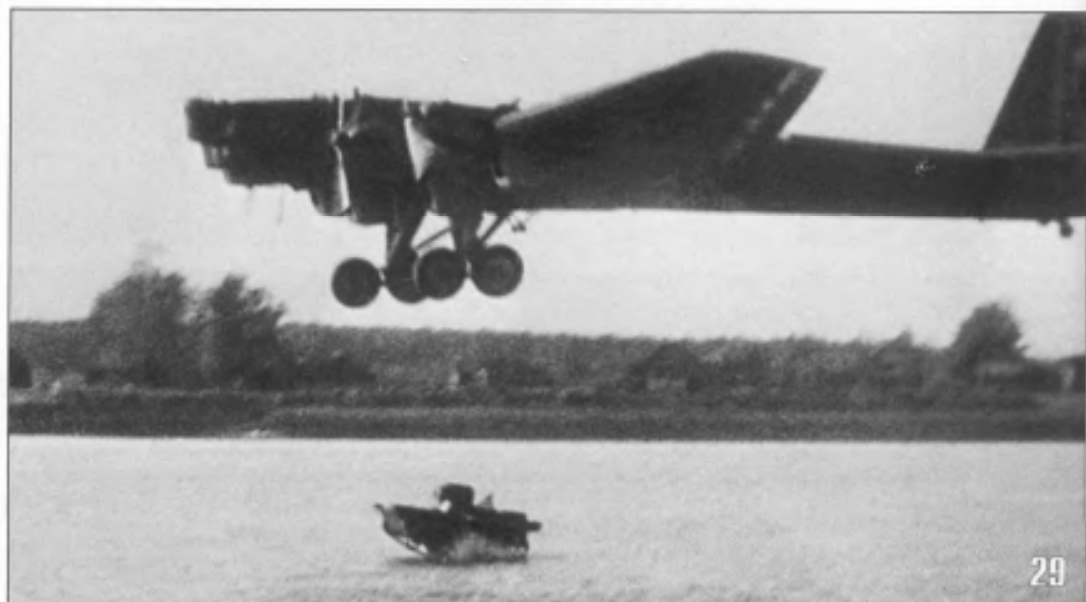
28—30. Кадры сброса танка Т-37А на воду. Район Москвы, Медвежий озера, 1936 год (АСКМ).
