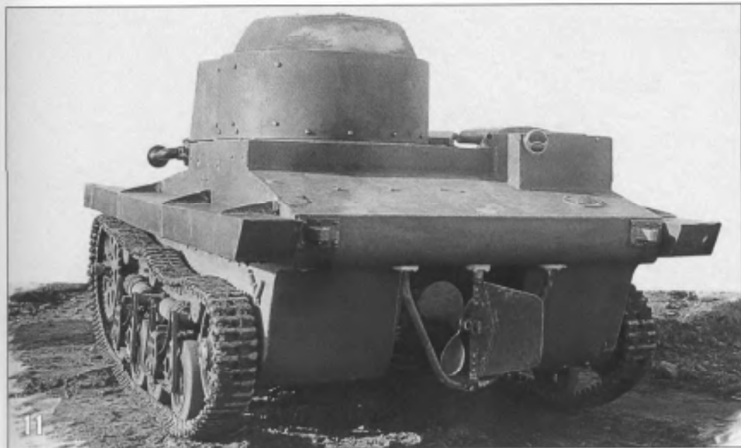
11, 12. Опытный образец танка Т-37 конструкции ОКМО. 1932 год (АСКМ).
